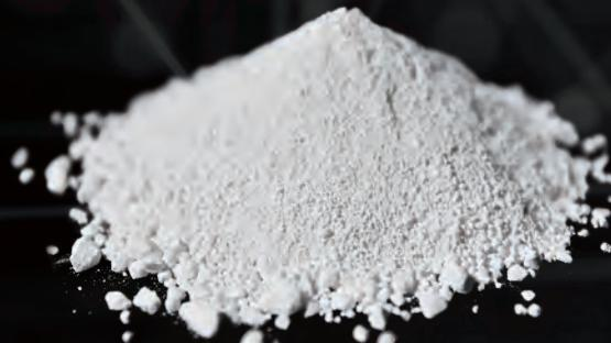
酸化チタンは、外壁塗料のベースとなる白塗料に配合されている重要な原料です。(化粧品、日焼け止めにも使われています)
