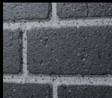
塗装する2色が明るい色と暗い色の差のある組み合わせは、塗り重ねた模様がなじまずにくっきりと出ます。その上にダイヤモンド塗装を施すとダイヤモンド塗装の特徴である斑がなじまず、汚れが付着しているように感じる可能性があります。
