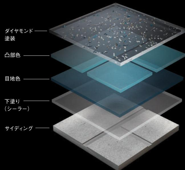
ダブルトーンダイヤモンドは既存のサイディングの表情を追求し、ダブルトーンの上に多彩模様を吹きつけた
